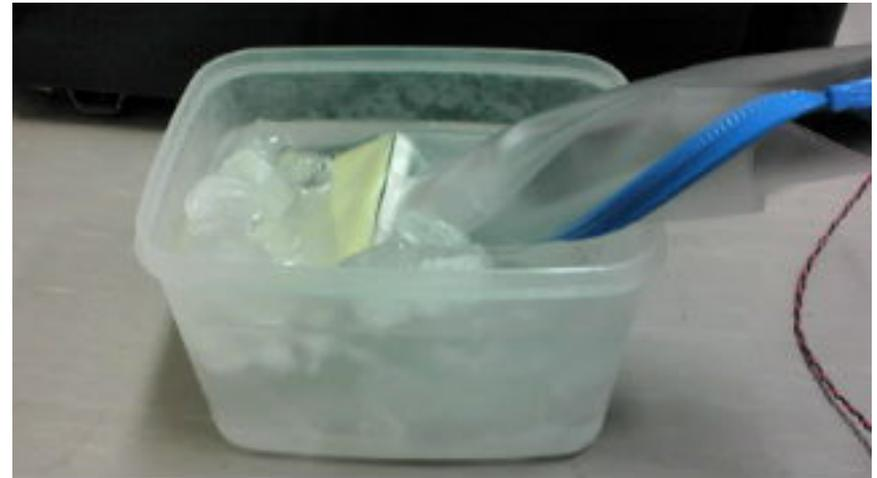
温度安定のため熱容量の大きい物体で覆う、氷水で0°C付近で安定させるなど工夫を施した
